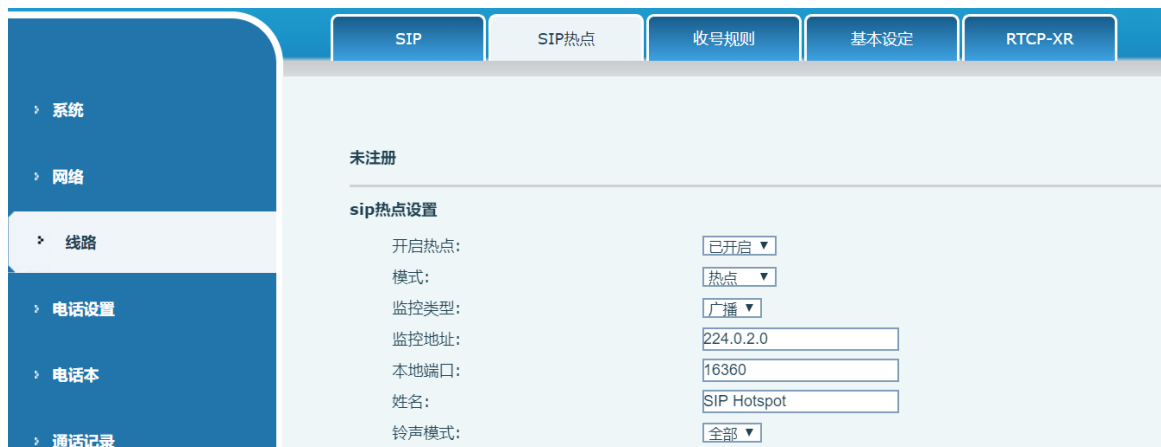
图 76 - 网页 SIP 热点服务器端设置
