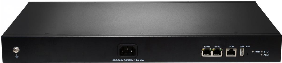
图1-8 MX60E 设备后面板-交流电源模块
