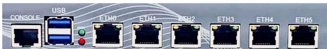
图 3: 前面板图示 标明各接口和指示灯的位置
