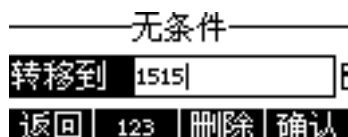
图 34 - 激活呼叫前转和配置呼叫前转号码
